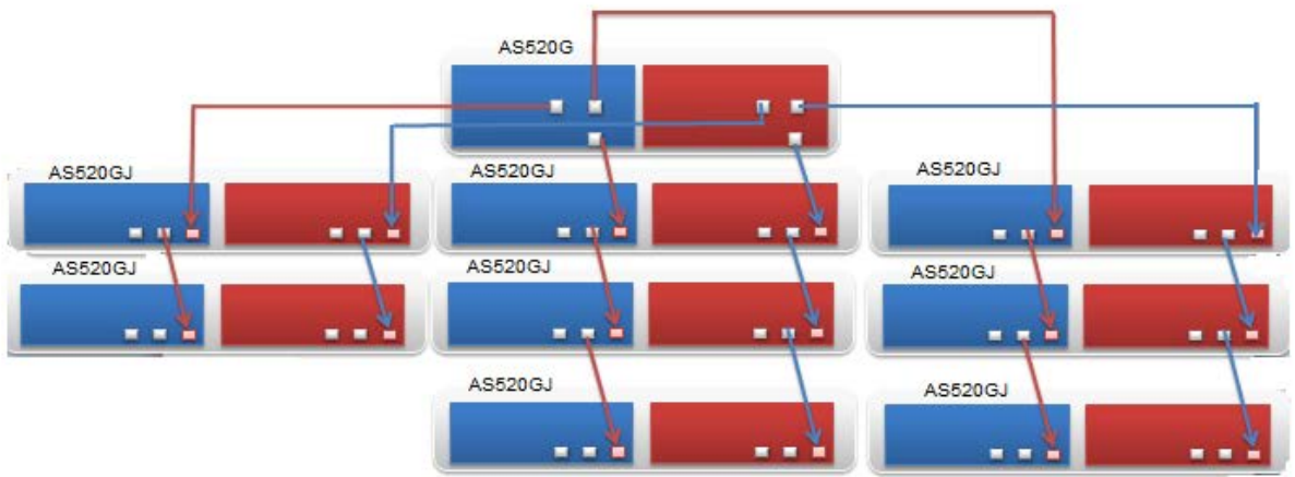
图 4-3 AS520GJ 与浪潮存储系统连接示意图
